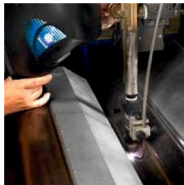
Автоматическая сварка протяженных швов по нержавеющей стали
