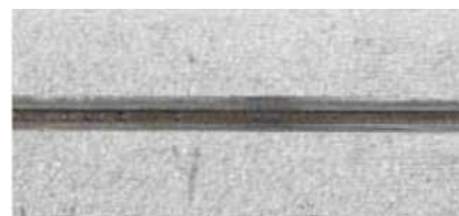
«Оцинковка», толщина 0.5мм, шов полученный в режиме Plasma-плавка
