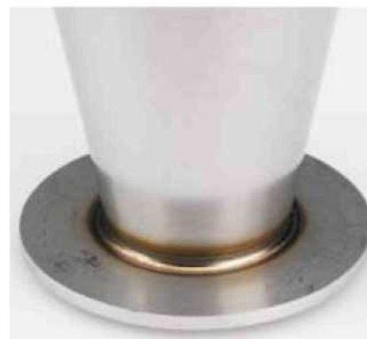
Сварка конического патрубка с листовым металлом в режиме plasma-пресс. Горловина патрубка имеет уменьшающую толщину.
