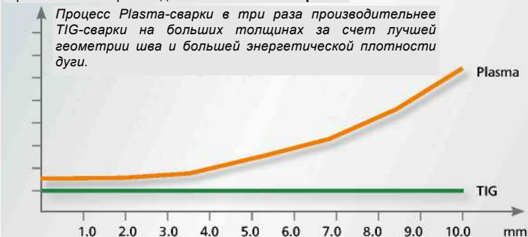
Plasma-сварка предпочтительней TIG-сварки на всех толщинах материалов
