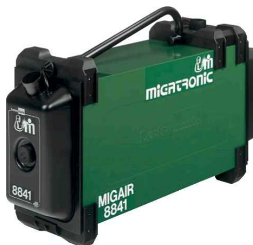
Пылесос MigAir 8841 MigAir 8841 оснащен системой автоматического вкл./выкл., подключенной к держателю рукава. Включается одновременно со сваркой, а отключается спустя 5-25 секунд после окончания сварки для более полного отвода сварочного дыма и паров. Также оснащен индикатором наполнения фильтра. Питание от сети 220 V. Артик. № ..... 82031011
