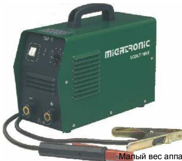
SCOUT 160E – простой в управлении аппарат, оснащенный функциями «Горячий старт» и «Мощность дуги», а также имеющий функцию стабилизации тока при изменениях сетевого напряжения. Сварщик может самостоятельно выбирать полярность электродов. Максимальный ток сварки 160 А достигается при применении предохранителей 20 А предохранителей.
